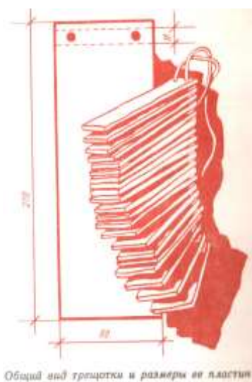
Общий вид трещотки и размеры ее пластин
